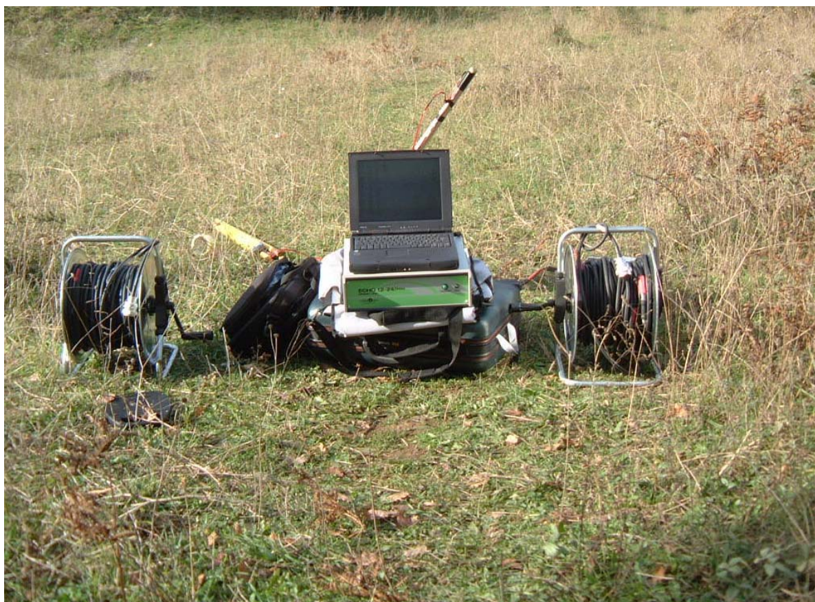
Sismografo 24 canali Ambrogeo mod. Echo 24/2002 Seismic UNIT
